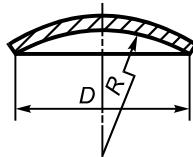
Рисунок 3 — Сферическое неотбортованное днище
