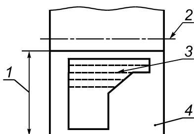
Рисунок 8 — Схема вальцовки фланца приварногостык по плоскости листа
