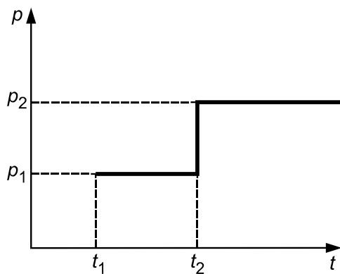
$p_1$  — давление пуска;  $p_2$  — рабочее давление;  $t_1$  — наимизшая температура воздуха, при которой допускается пуск сосуда под давлением  $p_1$ ;  $t_2$  — минимальная температура, при которой сталь и ее сварные соединения допускаются для работы под давлением в соответствии с требованиями приложений А—Д.
